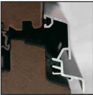
effiziente optimierte Regenschiene
