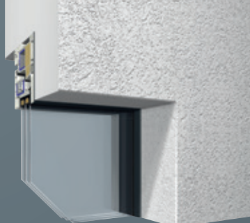
Laibungsvariante mit verdeckt liegenden Fensterrahmen
